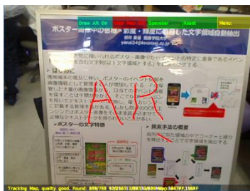
図6 本システムを使用してポスターに“AR”と描画したときの出力画像
