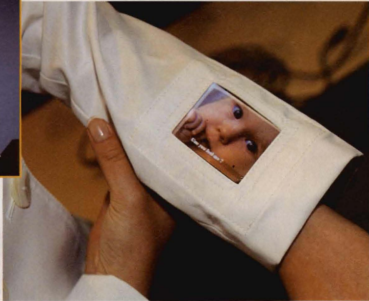
◆上着の袖に有機ELディスプレイを内蔵。フィルム基板を採用し、シワなどの形状変化にも耐えるような構造を目指している。
