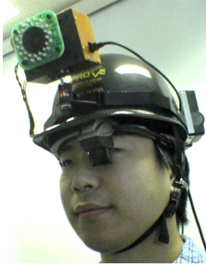
図3 ObjectCam2 装着外観
