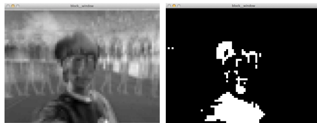
図 8 (左) 輝度の時間軸変動の分散 図 9 (右) 地面領域を基に 2 値化した結果
