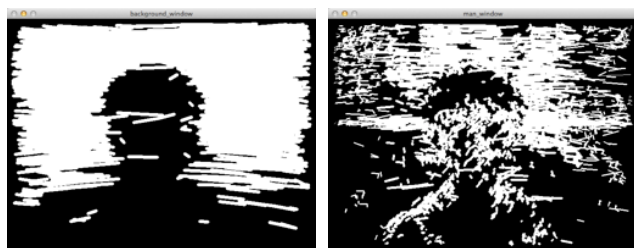
図 6 (左) 背景領域の特徴点移動軌跡の重畳結果 図 7 (右) 人物領域の特徴点移動軌跡の重畳結果
